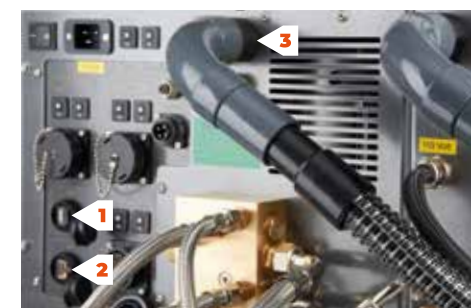
I 1. Connecteur USB pour le transfert des données 2. Prise réseau, par ex. pour le service à distance 3. Branchement pour aspirateur
