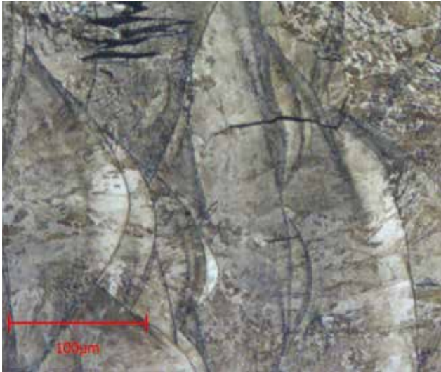
Abb. 8: Kontrastierte Probe. Die geschweißte Mikrostruktur des Bauteils ist deutlich erkennbar.
