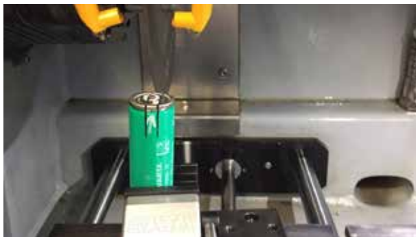
Schneiden einer kompletten LIB mit dem QATM-Trennschleifer
