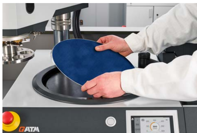
Platzieren von z.B. eines GALAXY Poliertuches auf der Magnetfolie
