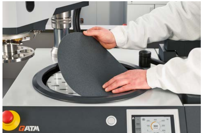
Platzieren von z.B. Schleifpapier mit Folienrückseite auf dem Haftträger
