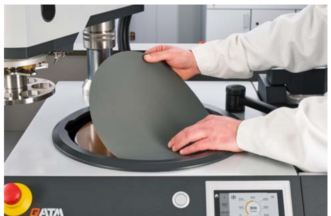
Platzieren von z.B. selbstklebendem Schleifpapier auf GALAXY X-Tap
