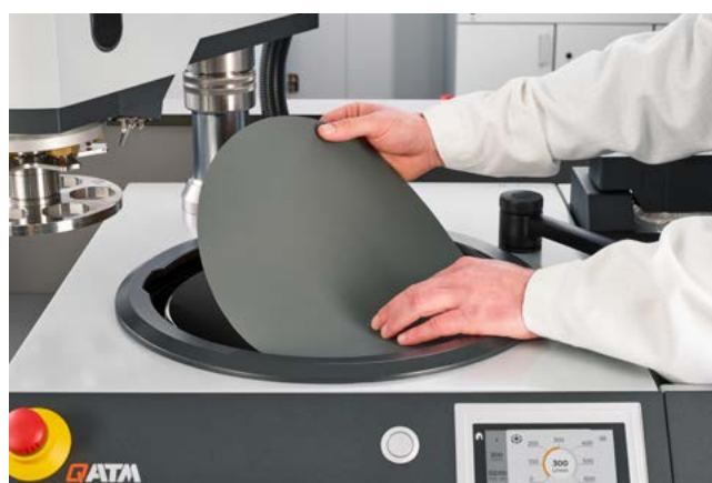
Platzieren von Schleifpapier ohne Rückseitenbeschichtung auf GALAXY Quick-Tap
