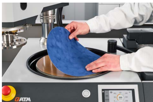
Platzieren von z.B: selbstklebenden Poliertüchern auf GALAXY X-Tap
