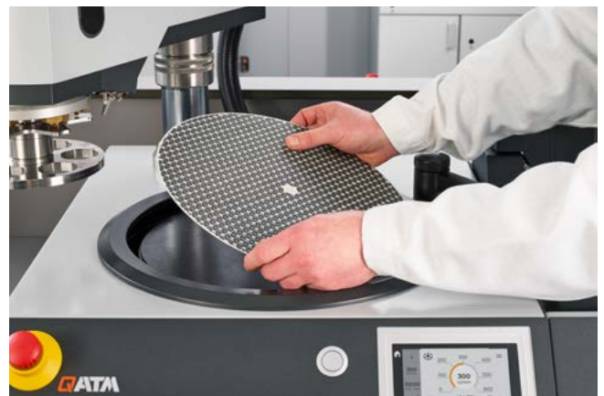
Platzieren von z.B. einer Diamantschleifscheibe auf der Magnetfolie
