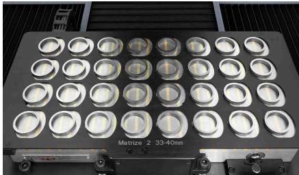
テストピースのクランピングとサンプルホルダーの認識
