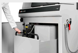
循環冷却ユニット
