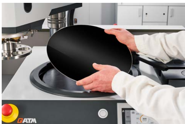
将Quick-Tap盘应用到磁性膜上
