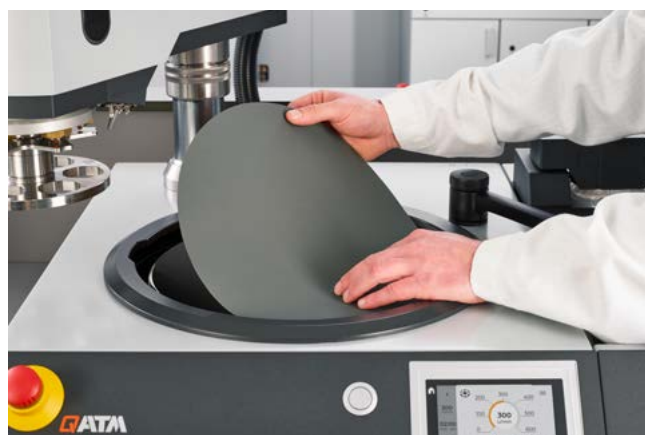
比如放置不带背胶/膜背衬的砂纸到Quick-Tap转换盘上
