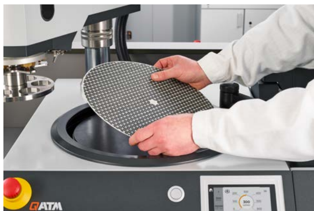
举例放置金刚石磨盘到磁性膜上
