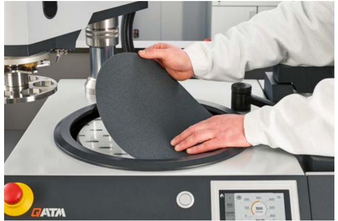
放置研磨介质比如带膜背衬砂纸到粘接转换盘上
