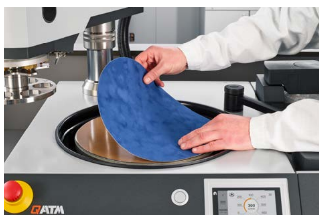
例如将自粘抛光布放置到GALAXY X-Tap转换盘上
