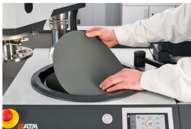
Placer par exemple du papier abrasif sans support adhésif/feuille sur le Quick-Tap
