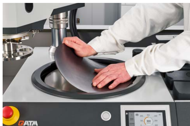
Application de la feuille magnétique
