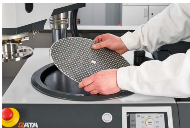
Placer, par exemple, un disque de meulage diamanté sur la feuille magnétique
