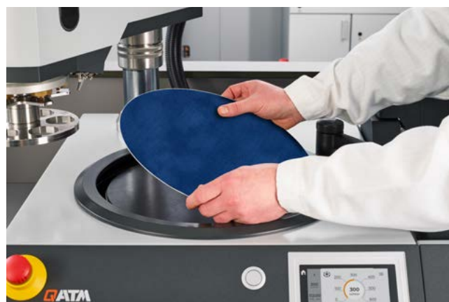
Placer, par exemple, un chiffon de polissage GALAXY sur la feuille magnétique
