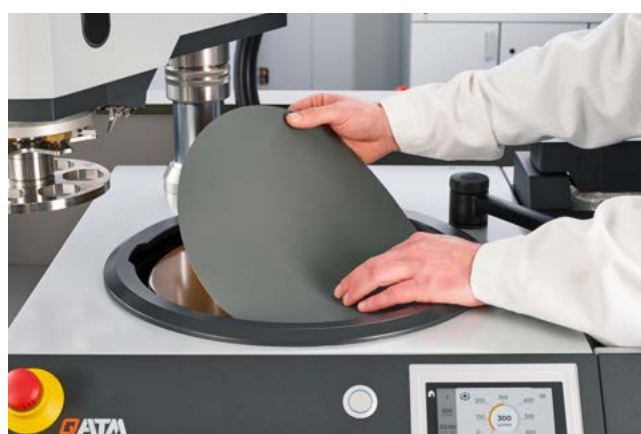
Placer par exemple du papier abrasif autocollant sur le GALAXY X-Tap
