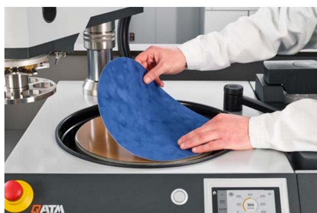
Placer par exemple un drap de polissage autocollant sur le GALAXY X-Tap
