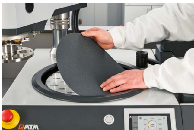
Placer, par exemple, un papier abrasif avec une feuille d'aluminium sur le disque de support adhésif
